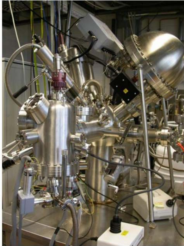
Abb. 5.2: Aufbau der Messapparatur zur Photoemissionsspektroskopie
